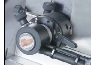
prélèvement sur le porte-échantillon du cryostat
